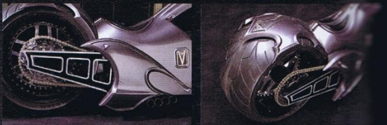
ジュラルミンを使用したスイングアーム、ドライブシャフトは車用を使用し、走行性能も考慮。サスペンションはエアサス化
